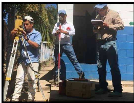
Medición topográfica de centros escolares en Ahuachapán, Santa Ana y Chalatenango.
